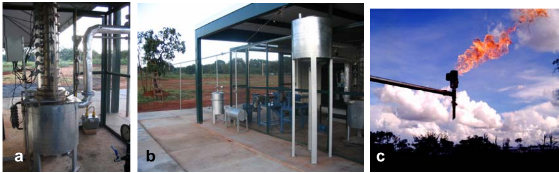
Figura 1: (a) Reator de craqueamento de óleos vegetais depois das modificações para otimizar o processo (b) Usina de de craqueamento de óleos vegetais depois das modificações para otimizar o processo e (c) Flare durante a queima dos gases produzidos pelo craqueamento de óleos vegetais.
